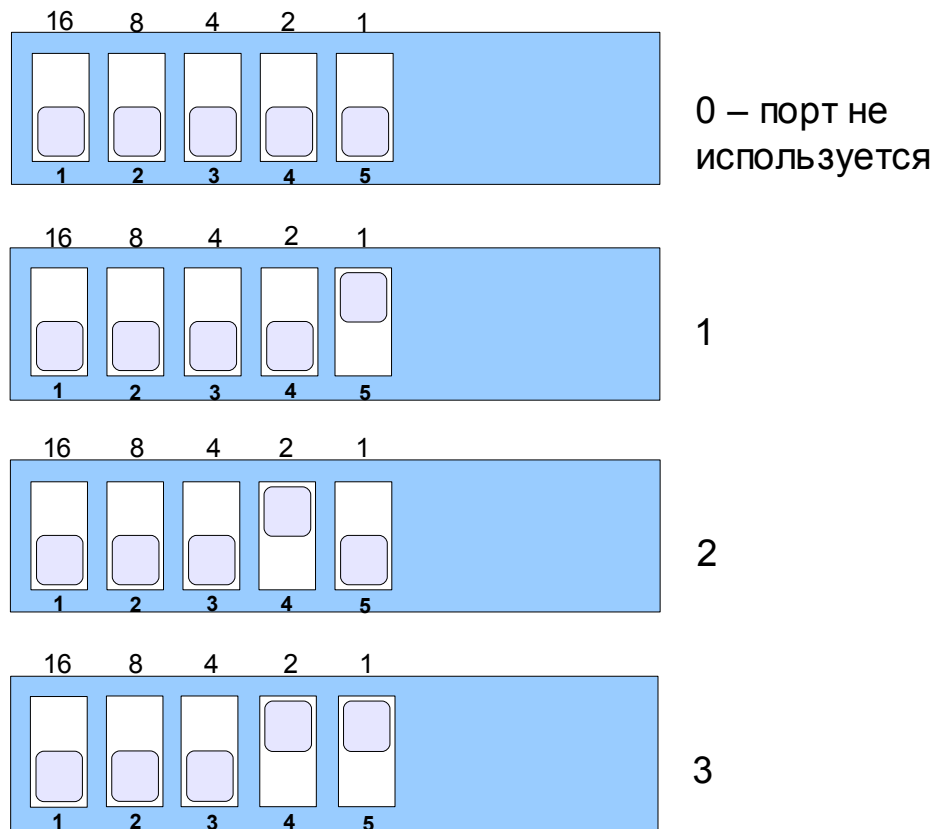
Рисунок 7 - Пример установки количества каналов при конфигурации портов E1_2, E1_3, E1_4
